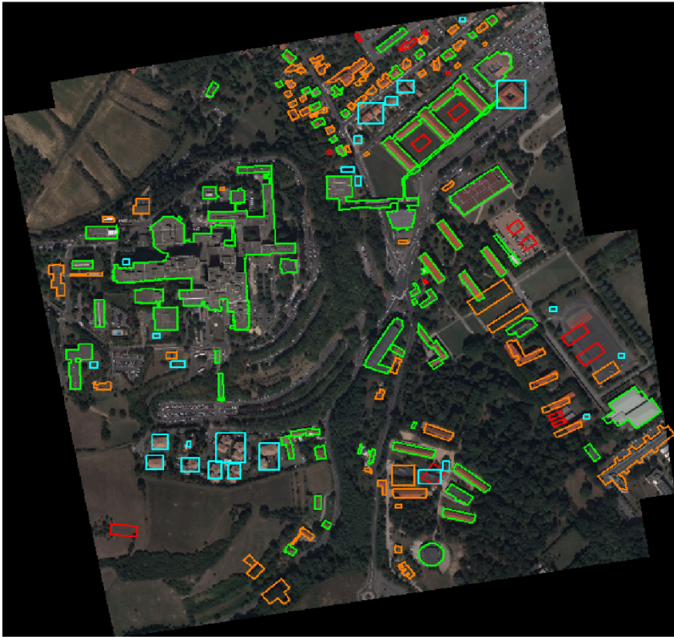
Fig 1. Type de carte de changement obtenue avec la méthode actuelle [2]. Les bâtiments de la BD, considérés non modifiés par le système apparaissent en vert; les bâtiments considérés modifiés ou détruits apparaissent en orange et rouge. Les nouveaux bâtiments apparaissent en bleu.
