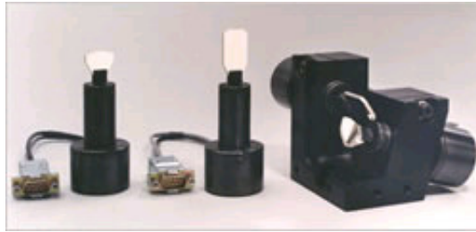
FIGURE 2 – Photographie des miroirs motorisés. De gauche à droite, le miroir de l'axe X, le miroir de l'axe Y et l'assemblage des 2 miroirs.
