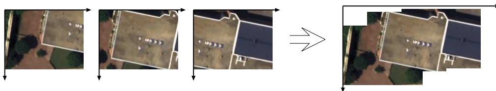
FIG. 8 – Exemple de Mosaïque d'images. Le SLAM permet de calculer la position relative des images avant de les fusionner dans une image commune.
